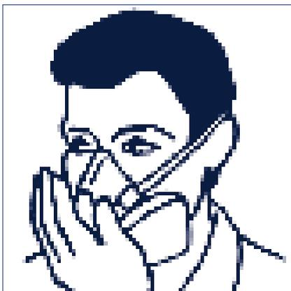
5. Vérifier l'étanchéité au visage en surpression ou en dépression (voir au dos). La méthode en surpression est recommandée.
