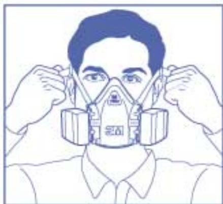
3. Serrer les brides inférieures à l'aide des réglages arrière. La tension des brides peut être diminuée en tirant à l'arrière des sangles.
