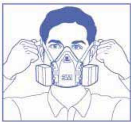
3. Serrer les brides inférieures à l'aide des réglages arrière. La tension des brides peut être diminuée en tirant à l'arrière des sangles.
