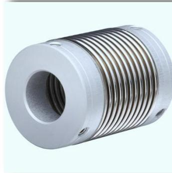
Les accouplements à soufflet en nickel sont constitués d'un soufflet métallique très flexible et de 2 moyeux de fixation. Leur assemblage est réalisé à la commande du client, permettant de répondre à une **grande variété de combinaison de diamètres d'alésage**, dans un délai très court.
