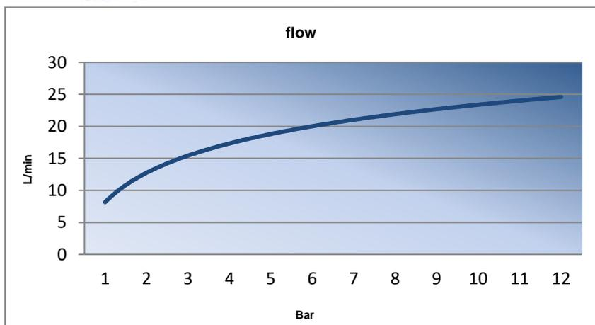
Débit d'eau en l/min lorsque le levier de commande est complètement rétracté, en fonction de la pression.
