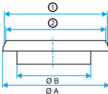
Schéma d'encombrement Réduction Plate Concentrique en aluminium
