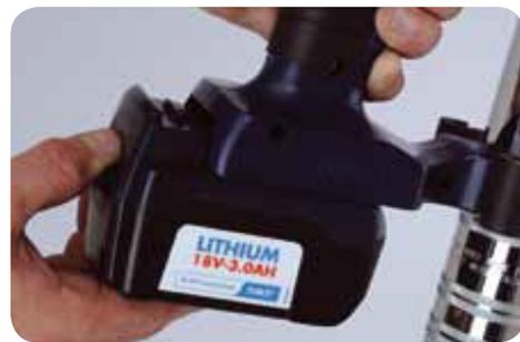
La batterie 18 V au lithium-ion à forte intensité (3,0 mA) / Réf. **07276010**, se met en place et se verrouille facilement.
