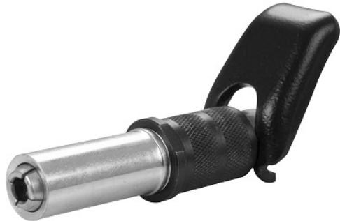
[Accessoire de graissage](#) avec système “main libre” à encombrement réduit ( $\varnothing$  15 mm) avec verrouillage et déverrouillage des 4 mors par action du levier, taraudage M10 x 100, emballage sous coque à l’unité.
