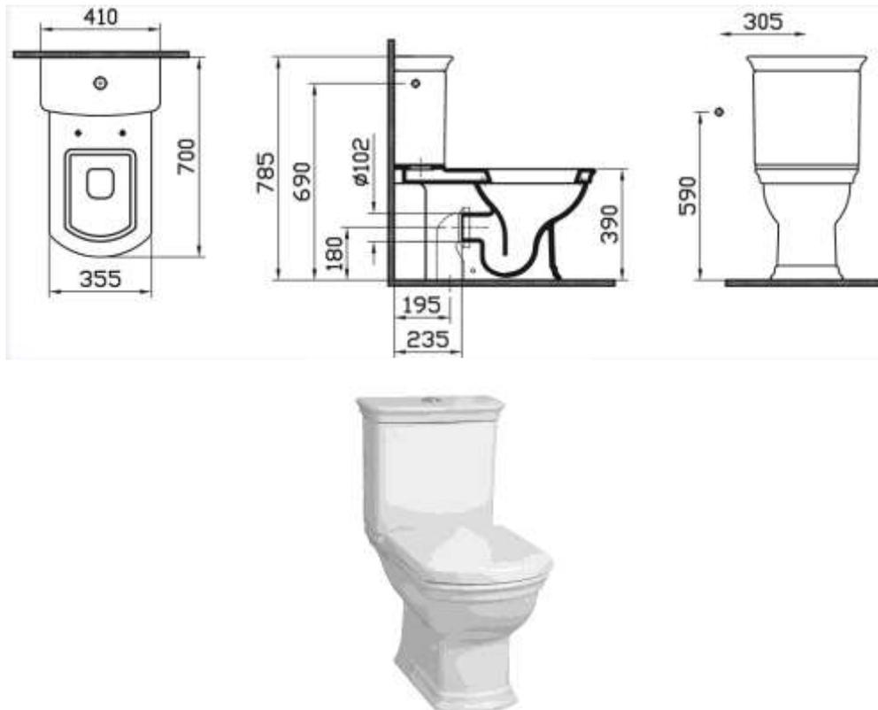
**Description produit :** Pack wc 3/6L Rétro, sortie horizontale, abattant Duroplast charnières métal, mécanisme 3/6L SIAMP
