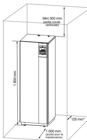
\* pour une installation du kit 2 circuits/pcbt prévoir un espace de 300 mm à l'arrière
