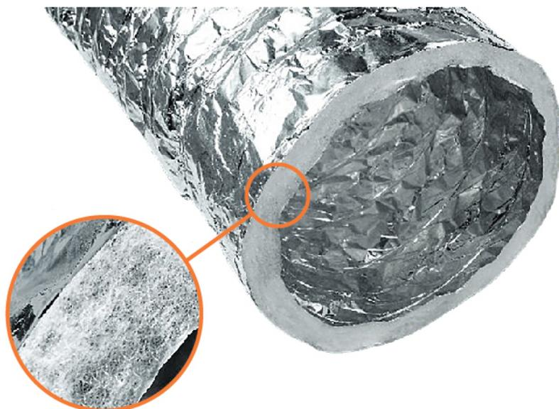
La nouvelle gaine souple isolée polyester multicouche BAILLINDUSTRIE est obtenue par la stratification de 2 couches d'aluminium avec un isolant à base de fibre de polyester.
