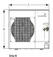
Unités extérieures modèles de 4,5 à 8 kW Hauteur : 600 à 943 mm Largeur : 840 à 950 mm (selon modèle)
