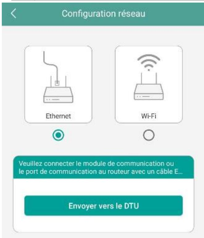
Branchez la passerelle via un câble RJ45 à la box internet, sélectionnez Ethernet sur l'application puis appuyez sur "Envoyer vers le DTU"
