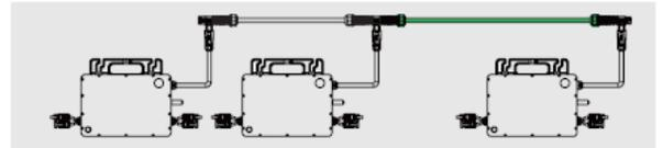
Pour débrancher le connecteur prolongateur HMS de l'interconnexion CA, vous devez utiliser un outil de démontage HMS.
