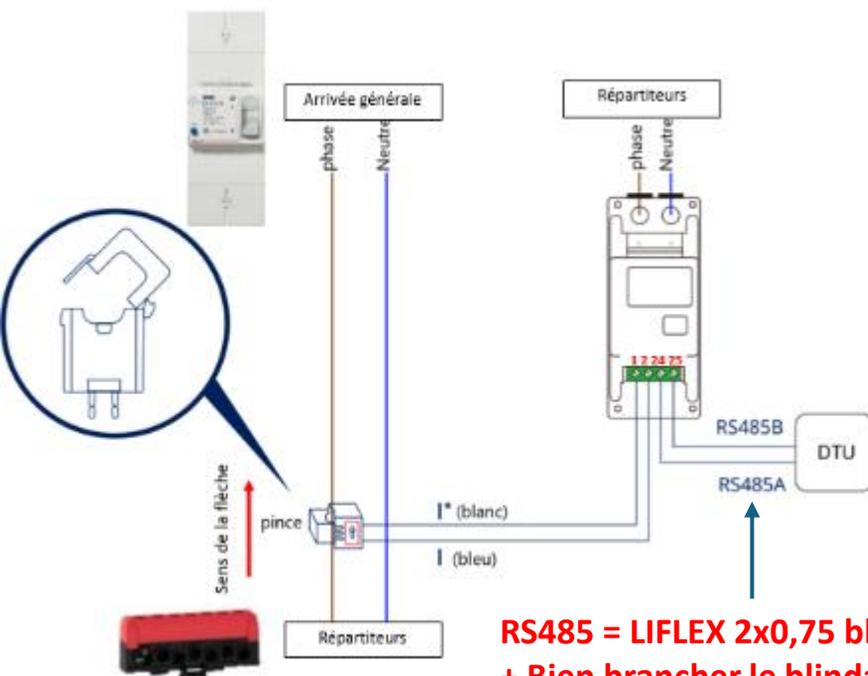
Alimenter le compteur avec la phase et le neutre sur les bornes 3 et 4 situées en partie haute du compteur.
