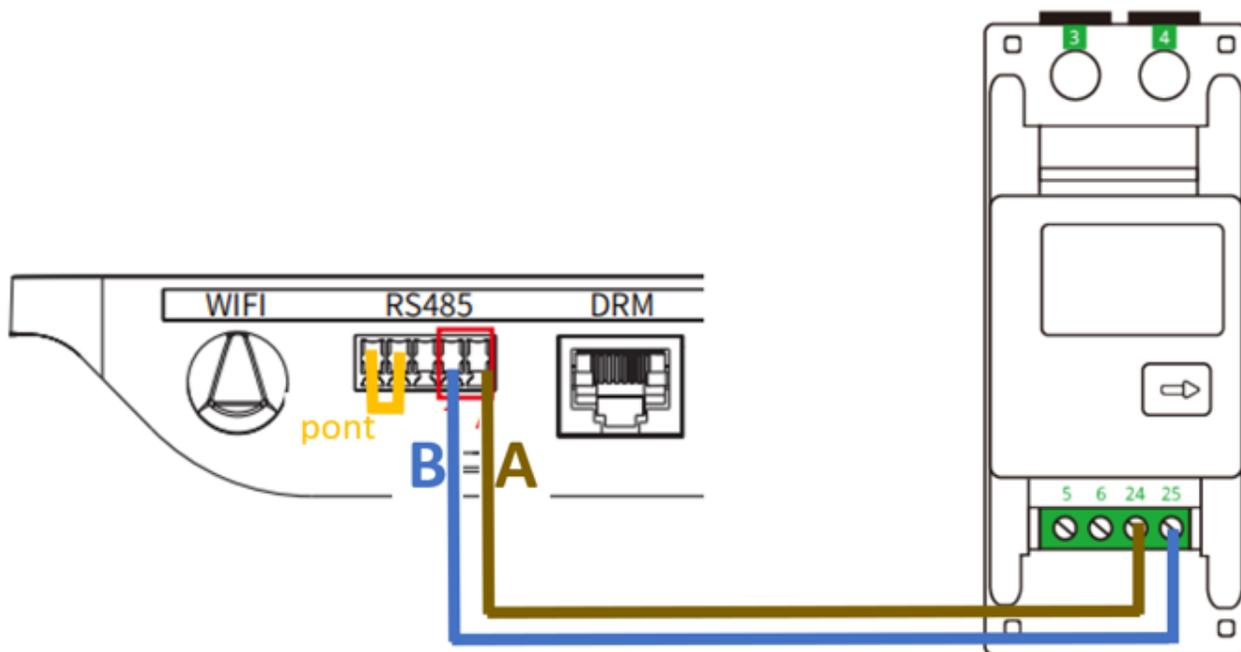
1. Connecter la borne 24 du compteur avec la borne A de la passerelle Horus.
