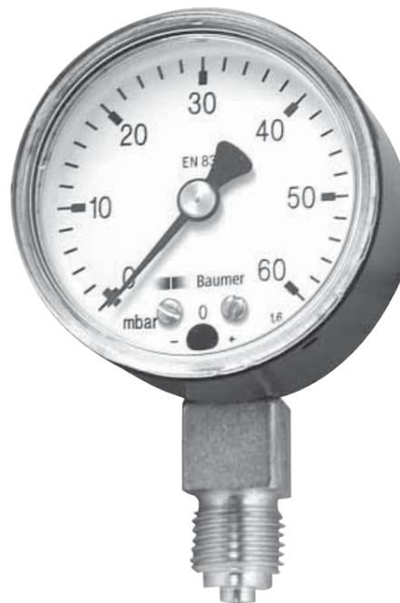
Les manomètres à capsule de la série **MTA** sont destinés à la mesure des basses pressions sur des gaz propres et non corrosifs, dans une gamme d'étendues de mesure de -400...0 mbar à 0...600 mbar.
