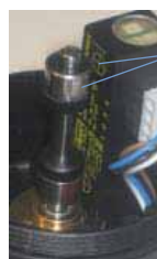
Mire de détection et came pour vanne ouverte
