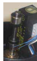
Mire de détection et came pour vanne ouverte
