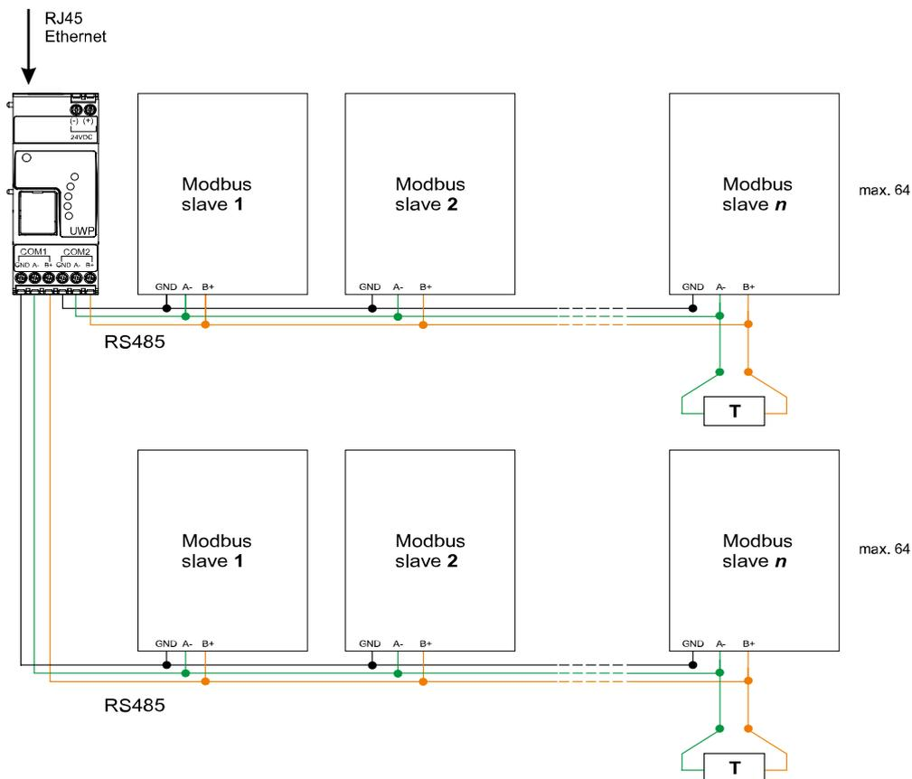
Fig. 1 Connexion Modbus RTU. COM 1 maître, COM 2 maître
