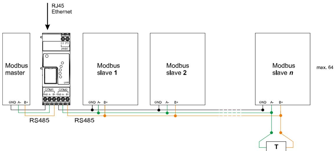
Fig. 2 Connexion Modbus RTU. COM 1 esclave, COM 2 esclave
