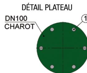
1. Boulons. Appliquer un couple de serrage de 2.37 m.kg par boulon
