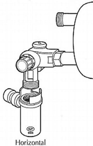
Montage en direct sur la tubulure du chauffe-eau par l'orifice femelle (1). Ne pas monter un groupe de sécurité de diamètre inférieur au diamètre des tubulures du chauffe-eau sur un chauffe-eau à chauffe directe.
