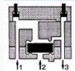
Le signal de sortie "S" est présent dès qu'un signal de pression "a" OU "b" est présent
