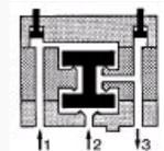
Le signal de sortie "S" ne peut être présent que si les signaux de pression "a" ET "b" sont présents
