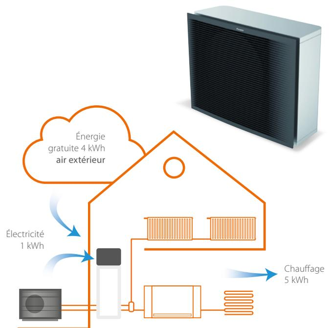
Explication : pour 1 kWh d'électricité consommée, la pompe à chaleur va restituer jusqu'à 5 kWh de chaleur selon les conditions climatiques et le type de logement.
