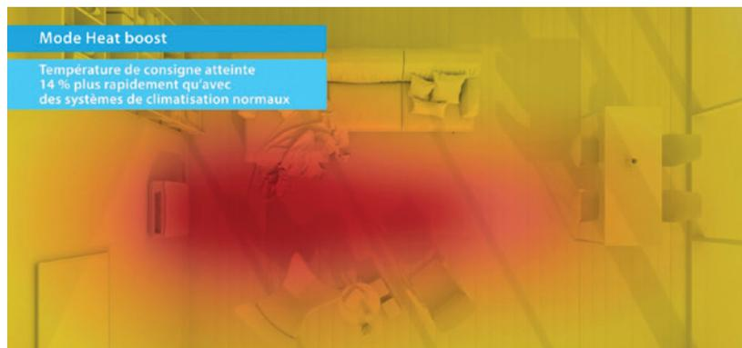
\* En combinaison Monosplit uniquement avec les groupes de type RXM-R(9). Conditions de test de la fonction "Heat Boost": Démarrage à 2 °C temp. extérieure, 10 °C température intérieure, et température de consigne de 23 °C. Résultat obtenu pour le modèle 3,5 kW.
