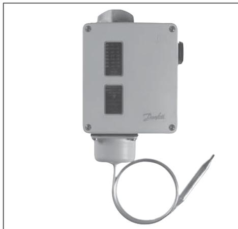
Les thermostats RT comportent un contact inverseur unipolaire commandé par température. La position de ce contact est fonction de la température du bulbe et de la valeur de consigne. La série RT comprend des thermostats à usage général, maritime et industriel, y compris thermostats différentiels, thermostats à zone neutre réglable, ainsi que thermostats à bulbe d'ambiance, à bulbe au bout d'un capillaire gainé et à bulbe au bout d'un capillaire.
