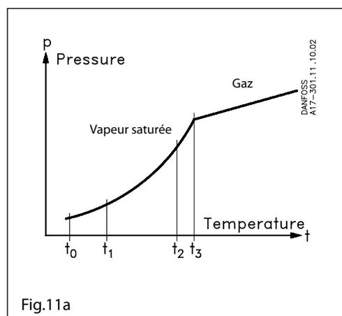
**Appareils RT à charge à adsorption**
