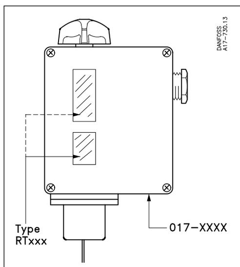
La référence du type se trouve sur l'échelle de réglage et le numéro de code est gravé au fond du boîtier du thermostat.
