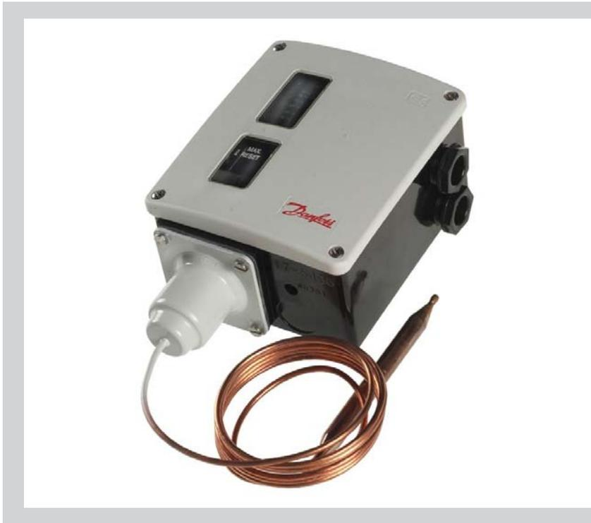
Les thermostats RT intègrent un inverseur unipolaire commandé par température dont la position dépend de la température du capteur et de la valeur de réglage.
