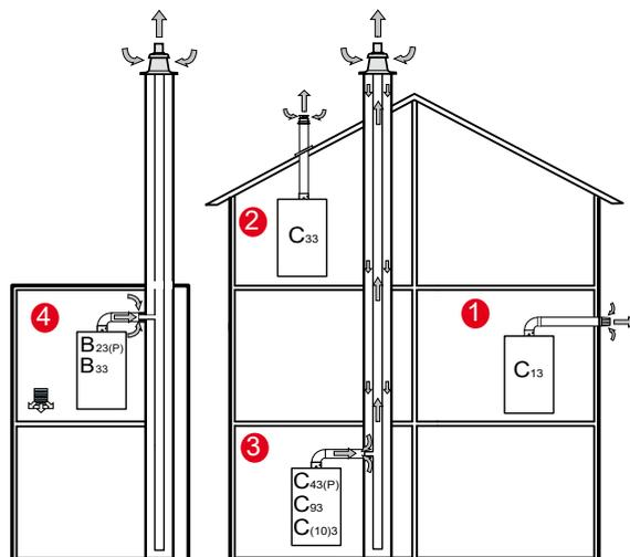
La chaudière MPX 2 est un appareil comprenant le ventilateur en amont de la chambre de combustion/de l'échangeur de chaleur.
