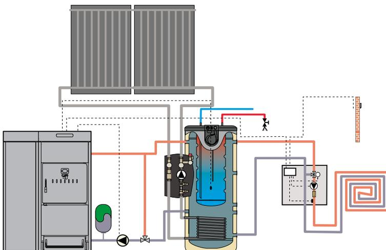
L'ensemble PACK UNIT DT BT DUO SOLAR inclut l'essentiel des équipements nécessaires pour mettre en oeuvre une installation de chauffage et la production d'eau chaude sanitaire par accumulation avec appoint solaire pour une chaudière a granulés avec appoint bois bûche DUAL THERM.
