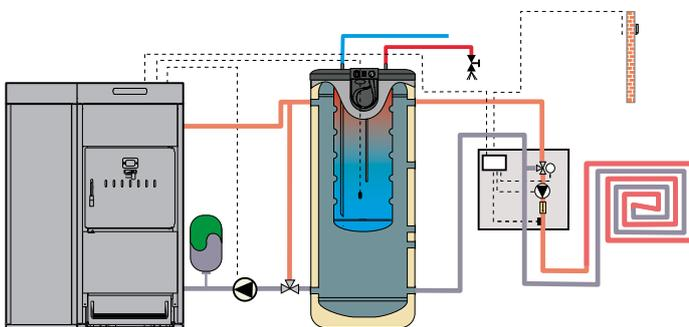
L'ensemble PACK UNIT DT BT DUO inclut l'essentiel des équipements nécessaires pour mettre en oeuvre une installation de chauffage et la production d'eau chaude sanitaire par accumulation avec une chaudière a granulés avec appoint bois bûche DUAL THERM
