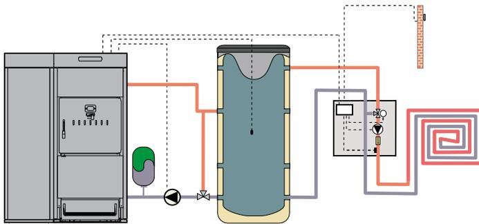
L'ensemble PACK UNIT DT BT inclut l'essentiel des équipements nécessaires pour mettre en oeuvre une installation de chauffage avec une chaudière a granulés avec appoint bois bûche DUAL THERM
