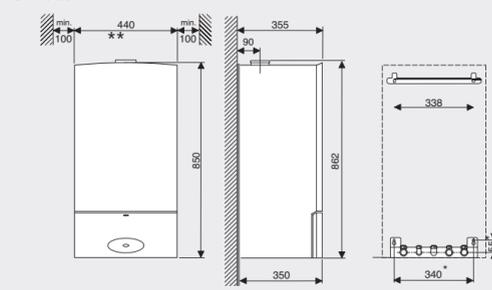
\*\* sortie fumisterie diamètre 80/125 mm.
