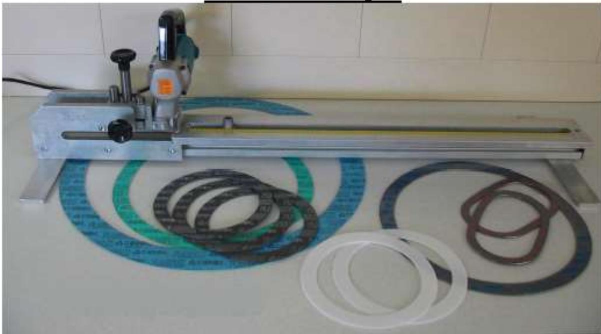
Le coupe joint EMICJ électrique est un instrument tenace et polyvalent, ce qui permettra de résoudre vos problèmes sur la découpe de joints plats à partir de feuilles et surtout pour joints en graphite avec renfort inox.
