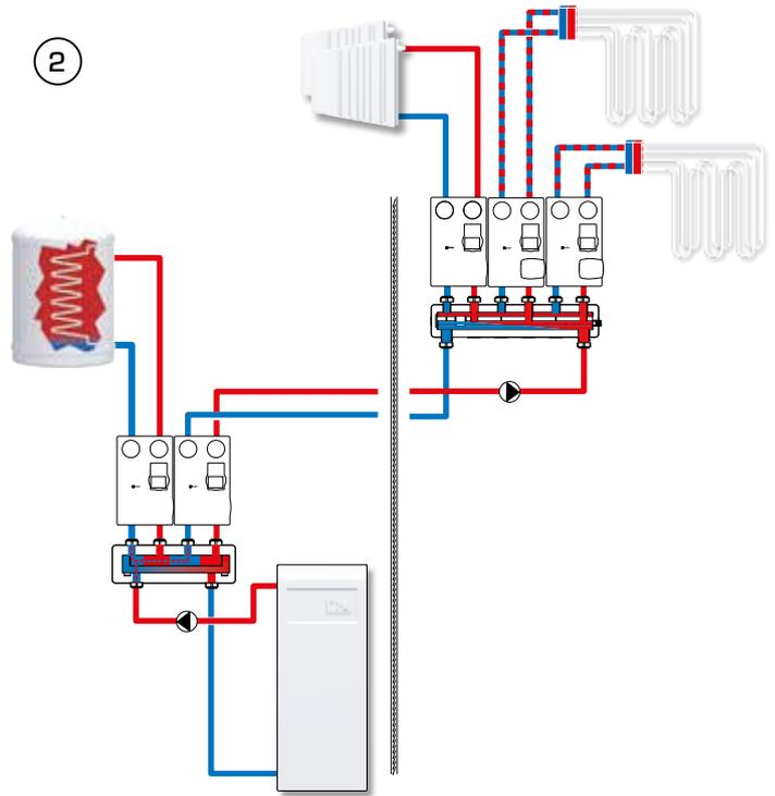
L'application montre une distribution de chaleur centrale avec chaudière et préparation d'eau potable, par exemple une chaufferie. Le système est divisé en zones, par exemple dans différents bâtiments ou étages. La fonction principale du groupe direct (GDx) est de fournir l'eau de chauffage avec une température de départ inchangée au récepteur de chaleur, à savoir un réservoir d'eau potable, des radiateurs ou d'autres groupes hydrauliques avec fonction de mélange.
