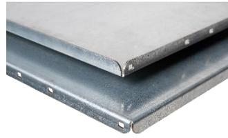
Plateau en tôle galva : épaisseur 2 mm, adapté aux milieux corrosifs, entretien facile, réversible (face avec et sans rebord de 16 mm).
