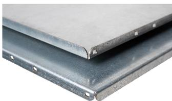
Plateau en tôle galva : épaisseur 2 mm, adapté aux milieux corrosifs, entretien facile, réversible (face avec et sans rebord de 16 mm).
