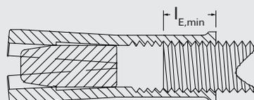
Profondeur de vissage minimum =  $I_{E,min}$
