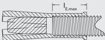
Profondeur de vissage maximum =  $I_{E,max}$
