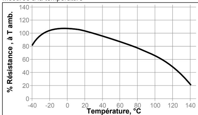
**Résistance au vieillissement à chaud : Vieillissement à la température indiquée et mesure après retour à 22 °C**
