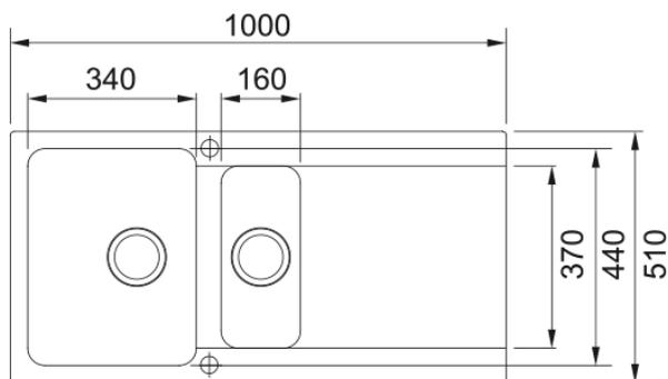
Evier ORION, OID 651 Blanc, à encastrer 1000x510 mm. Sa matière Tectonite avec sa surface non poreuse facilite le nettoyage et garantit une hygiène maximale. Vidage manuel, trop plein rond avec sa bonde, tous ces accessoires qui permettent une installation en toute tranquillité.
