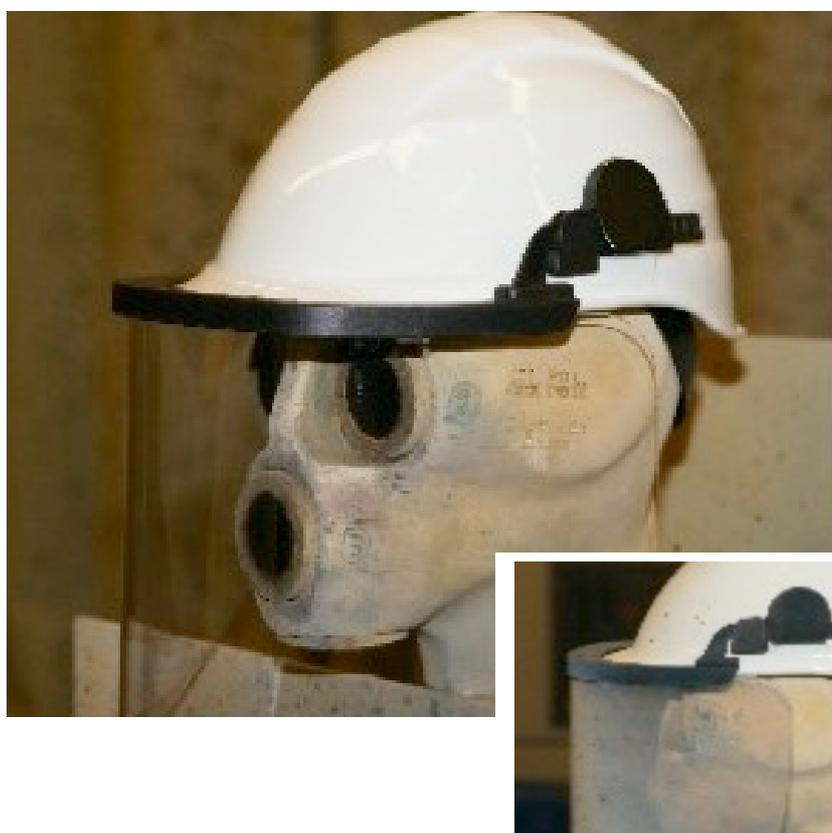
En combinaison avec le casque ROCKMAN ELECTRO l'écran 4201 en polycarbonate 1,5mm protège les yeux et le visage de l'électricien. Le grand écran (440 x 230mm) fournit une protection totale du visage y compris le menton. Le ROCKMAN ELECTRO avec l'écran 4201 est conforme à EN166 -1B8 ainsi que l'essai supplémentaire GS-ET-29 arc électrique de 4000A pendant 0,5 secondes.
