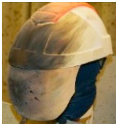
**L'E-MAN 7000** est muni d'un écran recouvert d'or ainsi que d'une cagoule en coton ignifuge pour fournir une protection à 7000A pendant 0,5 secondes.
