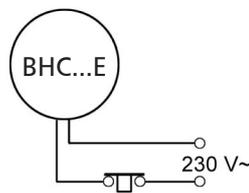
L'alimentation est faite par l'intermédiaire du va et vient qui alimente l'éclairage.
