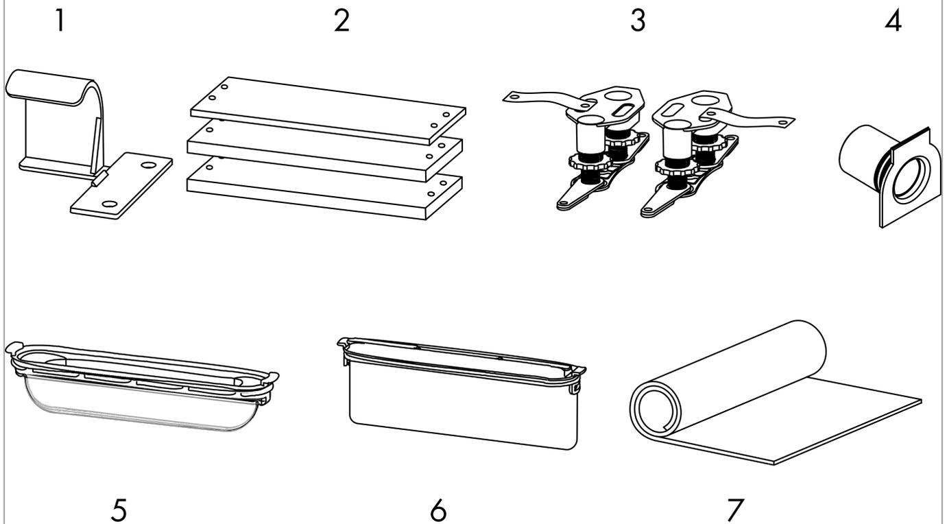
**uBox universal****Corps d'encastrement pour caniveau de douche linéaire pour installation à faible hauteur**Finition: Numéro d'article: **01000180**
