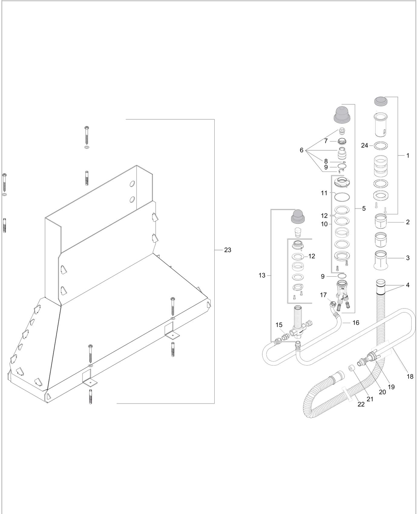
**Corps d'encastrement pour mitigeur de baignoire 3 trous**Finition: Numéro d'article: **13437180**
