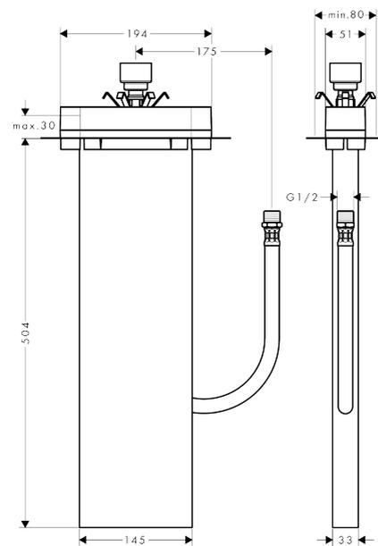
**sBox****Corps d'encastrement pour support de douchette sur bord de baignoire ou plage de carrelage**Finition: Numéro d'article: **13560180**
