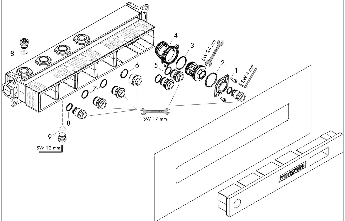
**RainSelect****Corps d'encastrement pour module thermostatique encastré avec 2 fonctions**Finition: Numéro d'article: **15310180**
