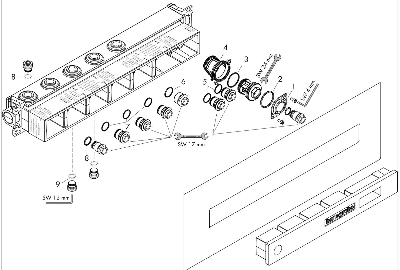
**RainSelect****Corps d'encastrement pour module thermostatique encastré avec 3 fonctions**Finition: Numéro d'article: **15311180**
