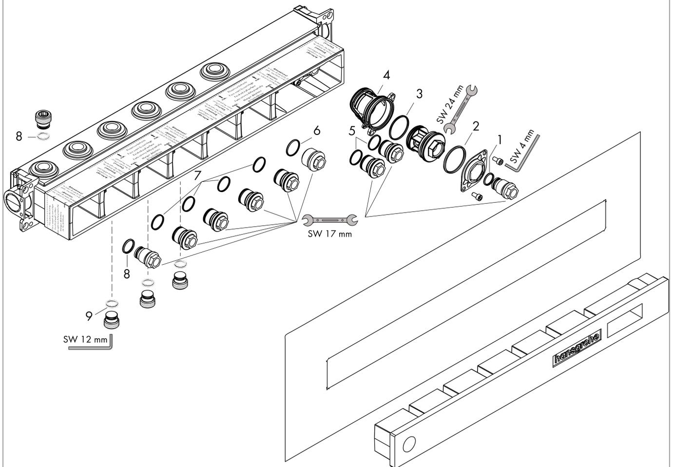
**RainSelect****Corps d'encastrement pour combiné thermostatique encastré avec 4 fonctions**Finition: Numéro d'article: **15312180**
