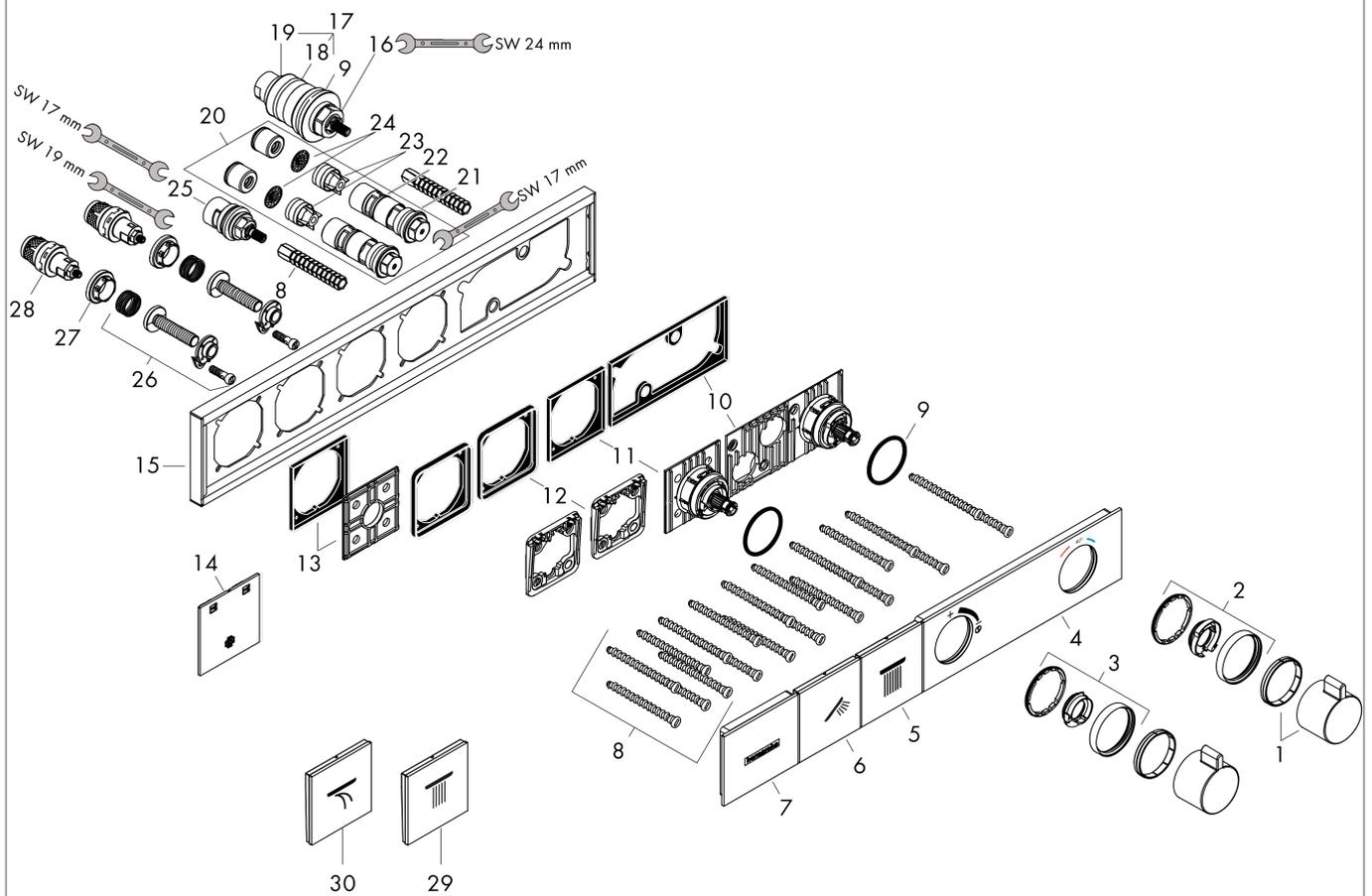
**RainSelect****Module thermostatique RainSelect encastré avec 2 fonctions**Finition: **Noir mat** Numéro d'article: **15380670****Liste des pièces détachées**
