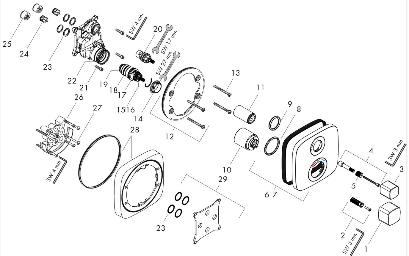
**Ecostat E****Set de finition pour mitigeur thermostatique encastré avec robinet d'arrêt**Finition: **Chromé** Numéro d'article: **15707000**
