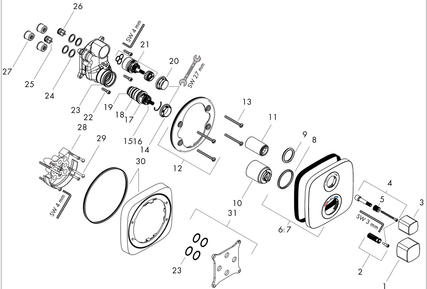
**Ecostat E****Set de finition pour mitigeur thermostatique encastré avec robinet d'arrêt et inverseur**Finition: **Chromé** Numéro d'article: **15708000**
