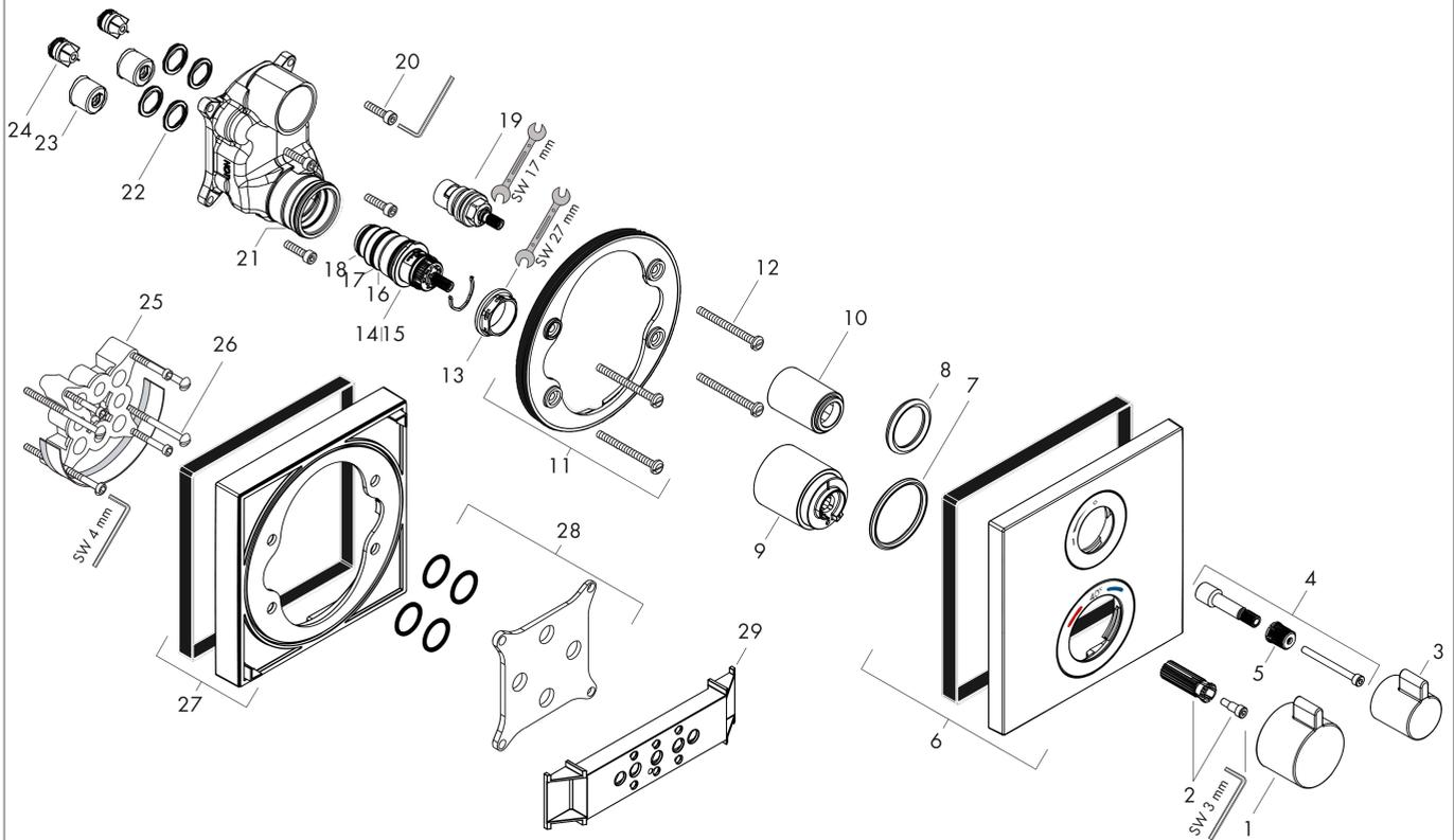
**Ecostat Square****Set de finition pour mitigeur thermostatique encastré avec robinet d'arrêt**Surfaces: **chromé** Numéro d'article: **15712000**
