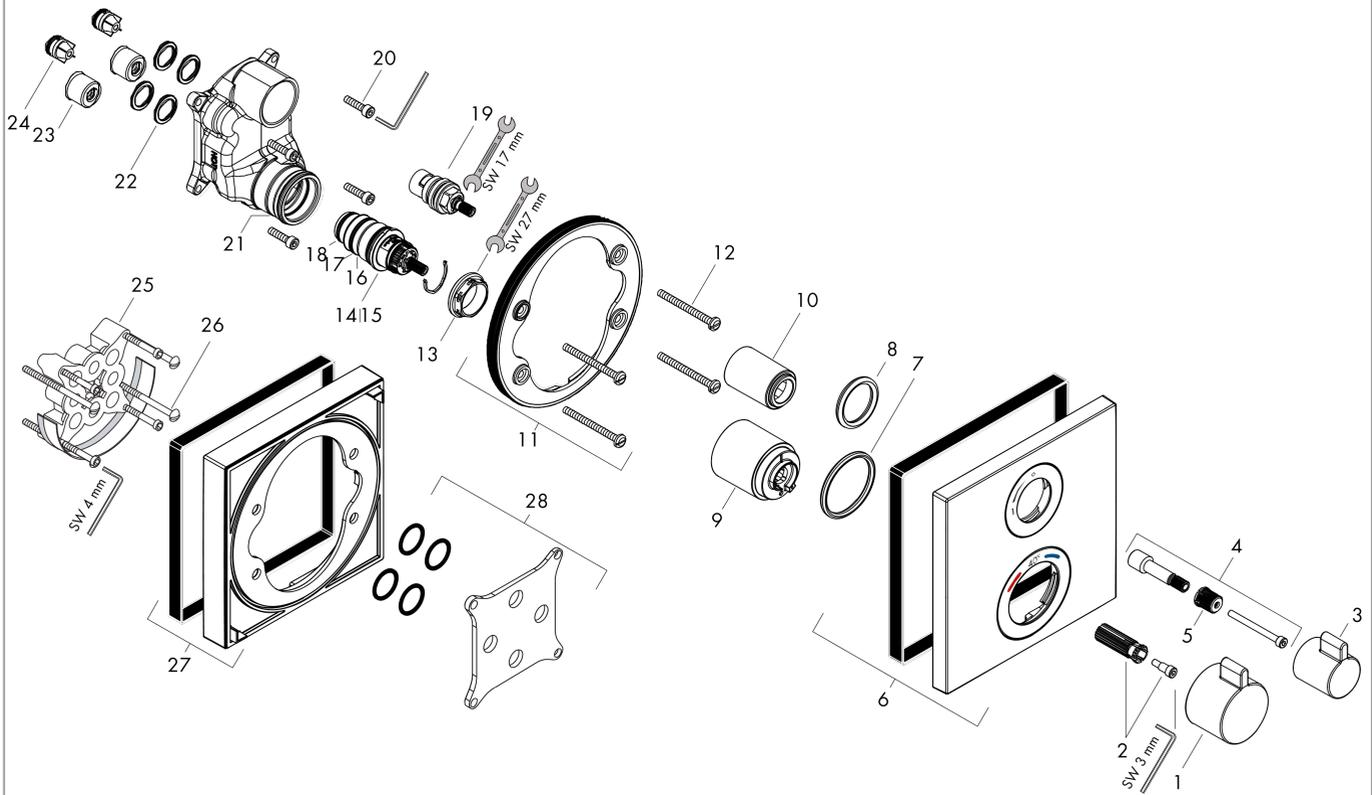
**Ecostat Square****Set de finition pour mitigeur thermostatique encastré avec robinet d'arrêt**Finition: **Chromé** Numéro d'article: **15712000**
