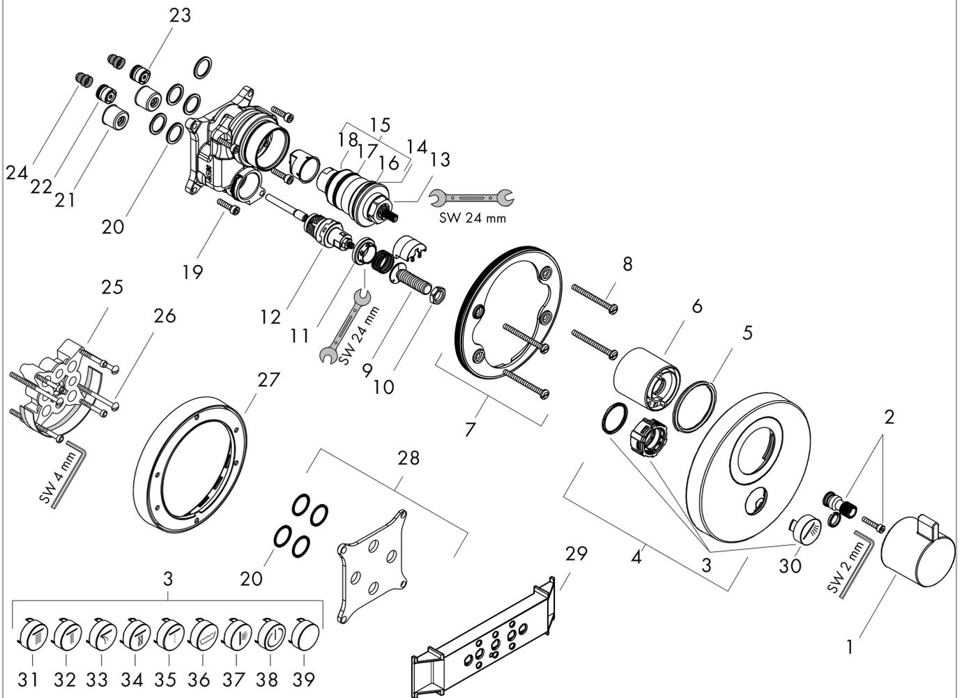
**ShowerSelect S****Set de finition pour mitigeur thermostatique encastré haut débit avec une sortie permanente et un robinet d'arrêt**Finition: **Chromé** Numéro d'article: **15742000**
