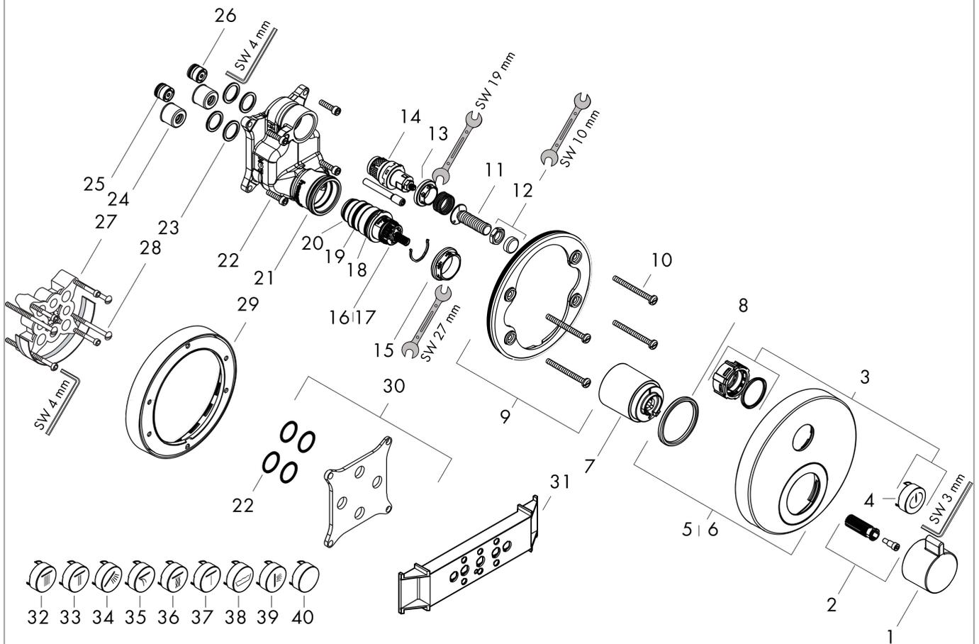
**ShowerSelect S****Set de finition pour mitigeur thermostatique encastré avec robinet d'arrêt**Finition: **Chromé** Numéro d'article: **15744000**
