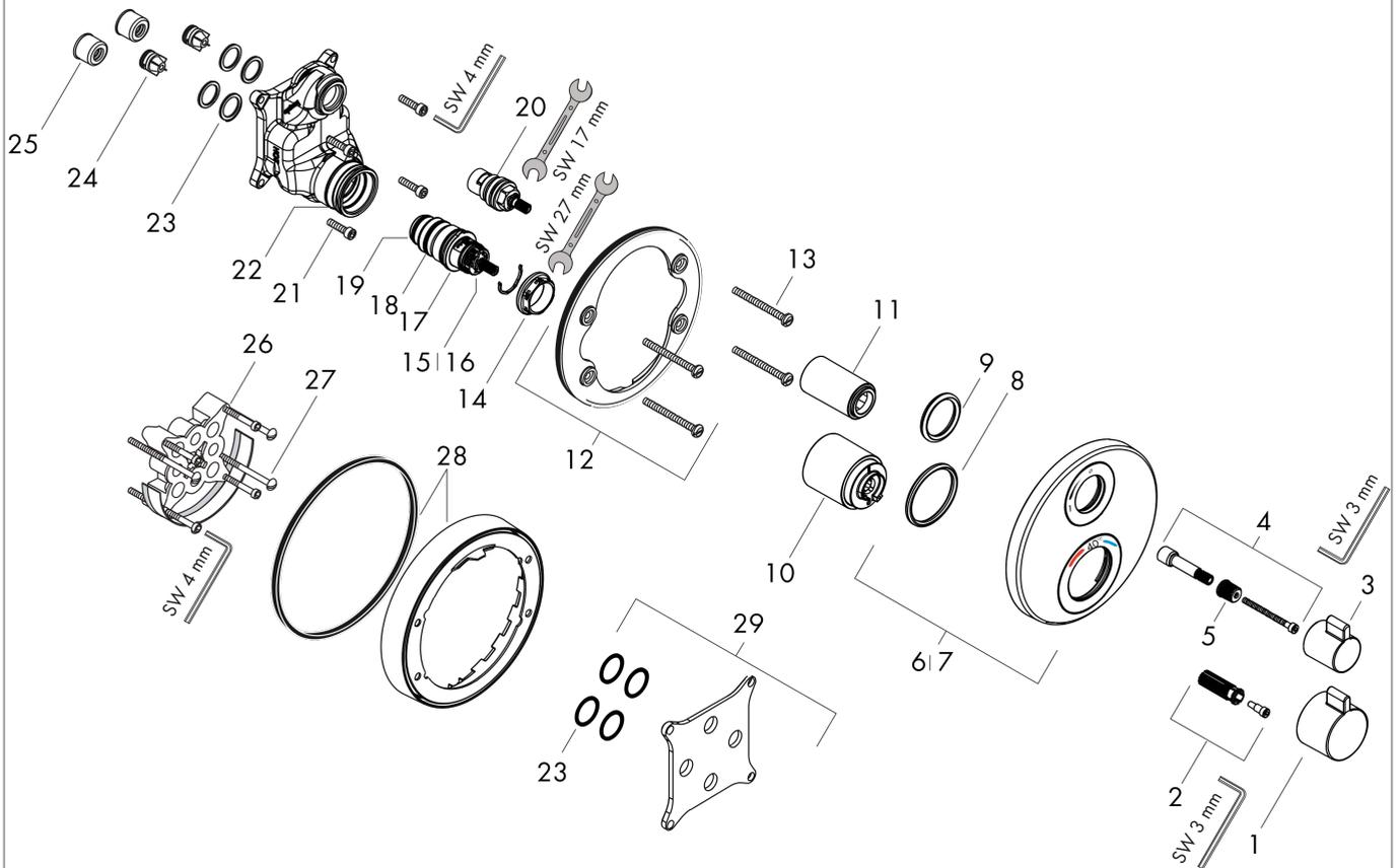
**Ecostat S****Set de finition pour mitigeur thermostatique encastré avec robinet d'arrêt**Finition: **Chromé** Numéro d'article: **15757000**
